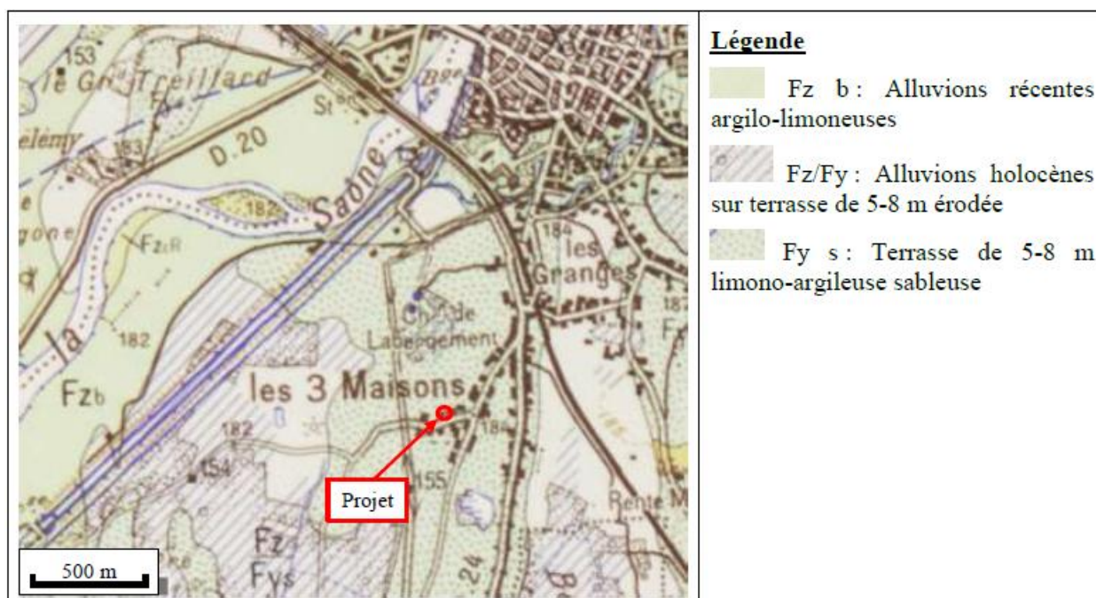
Situation géologique de l'ouvrage – document Géotec
