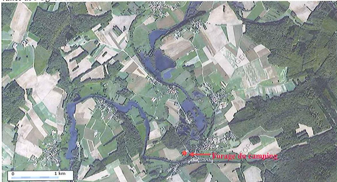
**La protection naturelle :** les formations alluvionnaires, dans lesquelles la ressource s'accumule et circule, sont affleuriées et ne disposent pas d'une couverture pédologique, limoneuse ou argileuse homogène. La nappe ne dispose donc pas d'une protection de surface naturelle effective.
