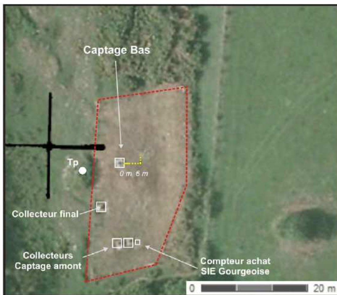
Figure 7 : Schéma du drain du Captage Bas suite à l'inspection vidéo
