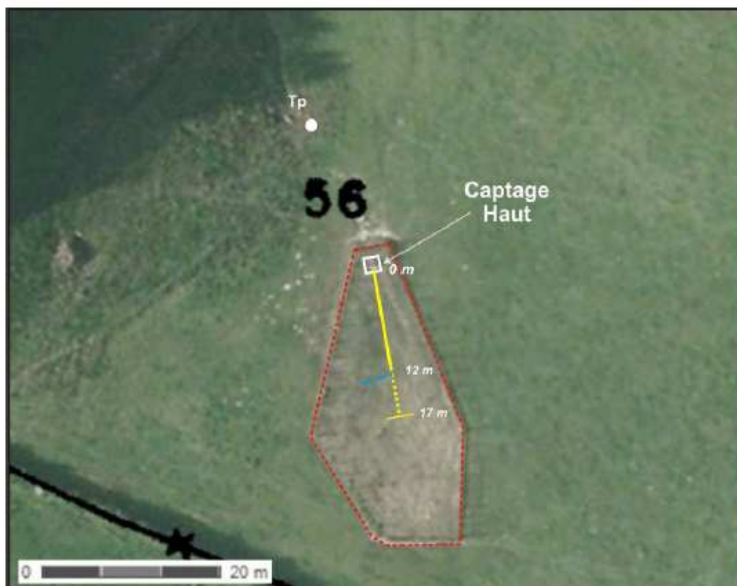
Figure 5 : Schéma du drain du captage Haut suite à l'inspection vidéo.
