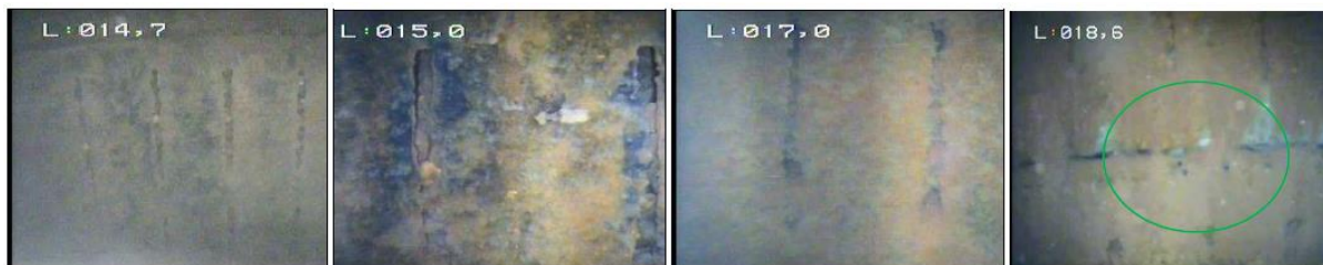
Figure 9 : Exemple de colmatage observé sur la crépine du puits 2
