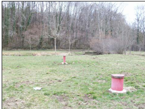
Clichés 5 & 6 : forage de la Fontaine de Vaucelles et piézomètre Pz1
