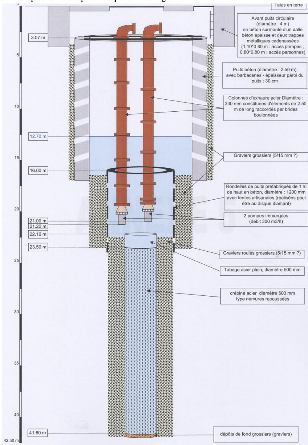
L'essai au micromoulinet (à 300 m<sup>3</sup>/h) confirme que les arrivées d'eau principales (75%) se situent entre 13 et 22 m, donc dans la nappe superficielle (au delà de 32 m le puits ne fournit que 6% du débit).
