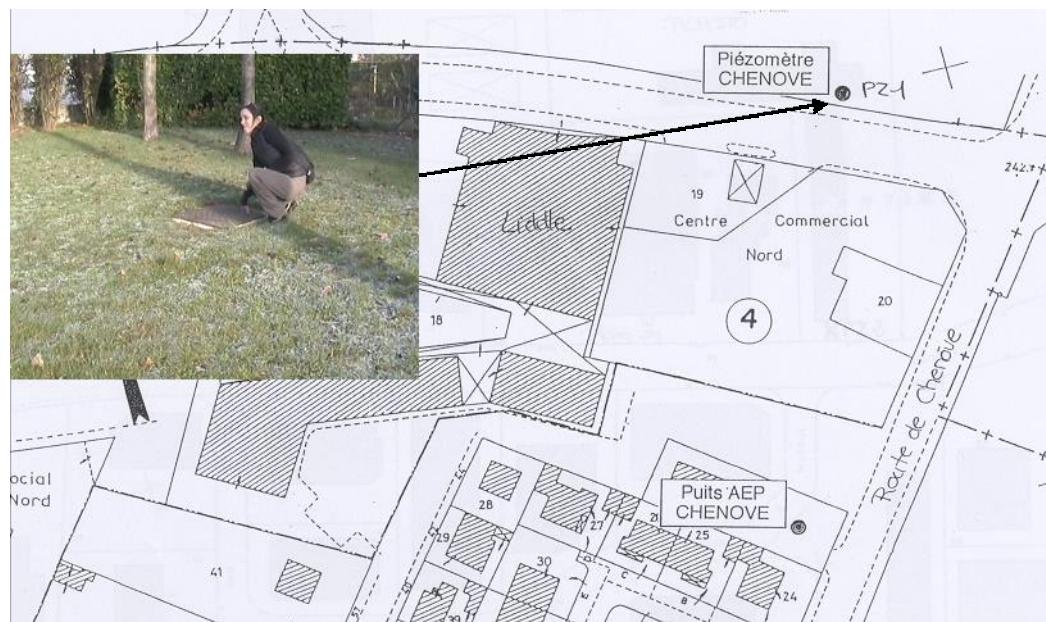
Les essais de traçage réalisés en 1992 ont montré qu'un produit injecté dans le piézomètre atteignait le puits en 5 jours, marquait un pic à 12 j et disparaissait après 23 j. Il a été également simulé qu'une pollution en amont de CHENÔVE se retrouvait au puits en 1 mois
